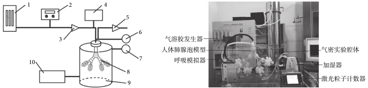
图2 可吸入颗粒物在人体肺腺泡区沉积实验模型 1.气溶胶发生器; 2.激光粒子计数器; 3.单向阀; 4.加湿器; 5.单向阀; 6.湿度传感器; 7.压差传感器; 8.人体肺腺泡模型; 9.气密实验腔体; 10.呼吸模拟器
